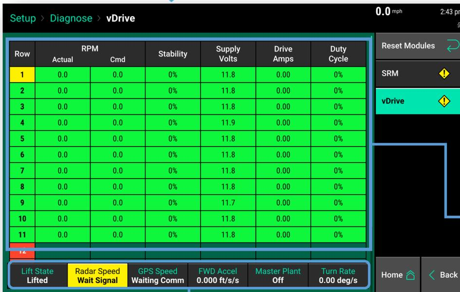
**RPM Actual** - The actual RPM of the vSet meter.
